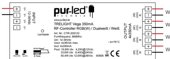
Info: Jeder W- Kanal kann mit bis zu 5A belastet werden, alle Kanäle werden gemeinsam angesteuert.
