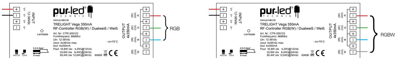
Info: Jeder Kanal kann mit bis zu 5A belastet werden, die Kanäle werden einzeln angesteuert.
