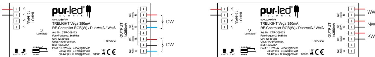
Info: Jeder Kanal kann mit bis zu 5A belastet werden, die Kanäle WW- und CW- werden jeweils gemeinsam angesteuert, die für tripleweiß werden einzeln gesteuert.
