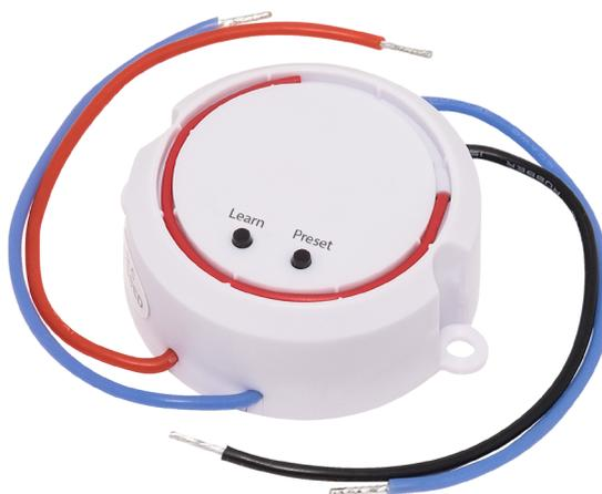
Der Funk TRIAC mini Unterputz aus dem TRELIGHT LED Dimmer Sortiment kann platzsparend und beinahe unsichtbar z.B. in einer Unterputzdose verbaut werden. Er dimmt in Kombination mit einer der Fernbedienungen oder einem Wandtaster Ihre 230Vac-Technik.
