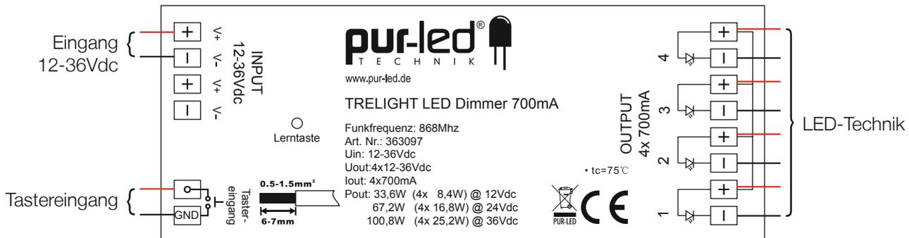
Anschließen der einfarbigen LED-Technik an die Output-Seite des TRELIGHT LED Dimmers:
