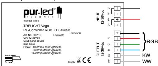
Info: Jeder Kanal kann mit bis zu 8A belastet werden, die Kanäle werden einzeln angesteuert.
