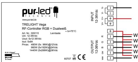
Info: Jeder W- Kanal kann mit bis zu 8A belastet werden, alle Kanäle werden gemeinsam angesteuert.
