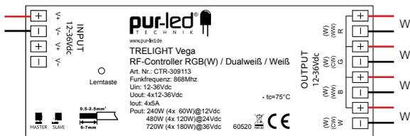
Info: Jeder W- Kanal kann mit bis zu 5A belastet werden, alle Kanäle werden gemeinsam angesteuert.
