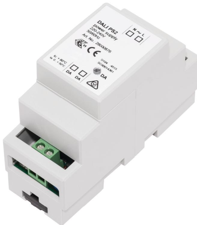
Dieses DALI PS2 Netzteil versorgt Ihre DALI Betriebsgeräte oder -Steuermodule ohne eigene Stromversorgung mit 240mA. Es ist zum Einbau in einen Schaltschrank vorgesehen. Das Netzteil speichert bei Stromunterbrechung seinen letzten Programm- und Einschaltzustand.
